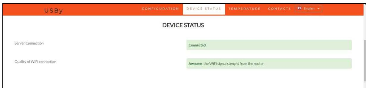
En el caso de que la calidad de la conexión WiFi no sea óptima, es recomendable acercar el USBy al Modem / Router y volver a comprobar tras un minuto de espera.
